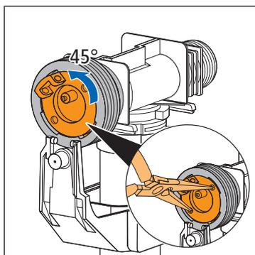
5. Den Befestigungskranz mit Hilfe einer Spitzzange durch eine 45°-Drehung gegen den Uhrzeigersinn lösen.
