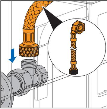
13. Den Panzerschlauch am Eckventil montieren.
