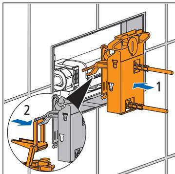
18. Die Betätigungsmechanik einsetzen und den Bügel an der Spülgarnitur einhängen.
