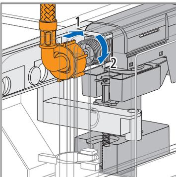
15. Den Panzerschlauch an das Füllventil ansetzen und handfest anschrauben. Dabei auf den richtigen Sitz des Panzerschlauchs am Füllventil achten.
