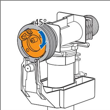
11. Den Befestigungskranz durch eine 45°-Drehung im Uhrzeigersinn festziehen.
