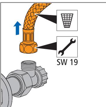
6. Den Panzerschlauch (SW 19) am Eckventil lösen und nach vorne aus dem Spülkasten herausnehmen und entsorgen.
