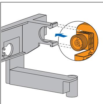
12. Das Füllventil in den Füllventilhalter einstecken, bis es spürbar einrastet.
