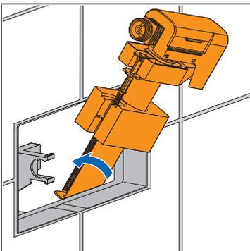
11. Das Füllventil in den Spülkasten einführen.
