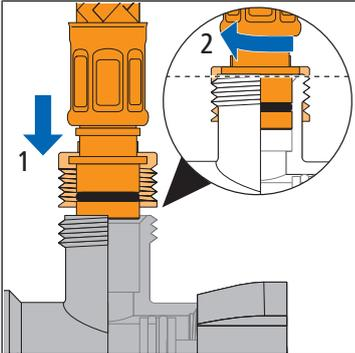
14. Den Überwurf des Panzerschlauchs handfest am Eckventil anschrauben. Darauf achten, dass der Panzerschlauch gerade auf dem Eckventil aufsitzt.
