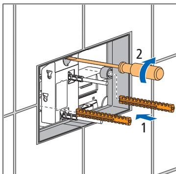
19. Den Spülkasten-Gewindebolzen-Satz montieren, um die Betätigungsmechanik im Spülkasten zu fixieren.
