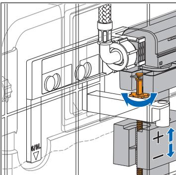
17. Die Füllstandshöhe im Spülkasten prüfen. Sie muss bis zur Markierung reichen. Wenn die Füllstandshöhe zu niedrig oder zu hoch ist, den Füllstand der Spindel nach justieren. Dazu den Schwimmer nach oben verstellen, um die Füllstandshöhe zu erhöhen und nach unten verstellen, um die Füllstandshöhe zu reduzieren.
