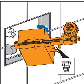
5. Das Füllventil im Spülkasten so drehen, dass es durch die Revisionsöffnung passt, aus dem Spülkasten herausnehmen und entsorgen.
