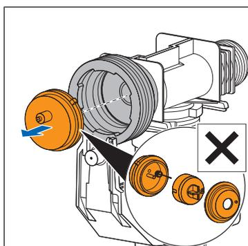
7. Das Membranventil demontieren. Dabei die Bauteile des Membranventils nicht auseinandernehmen, um Beschädigungen zu vermeiden.
