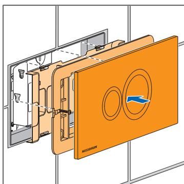
20. Die ggf. vorhandene Grundplatte, den Grundrahmen und die Betätigungsplatte montieren.
