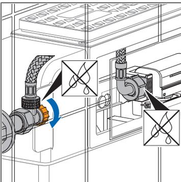
16. Das Eckventil öffnen und das Eckventil und den Anschluss des Füllventils auf Dichtheit prüfen.
