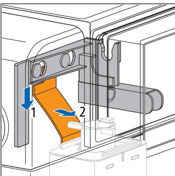
7. Die Sicherung des Füllventilhalters nach unten drücken und vor den Füllventilhalter heben.
