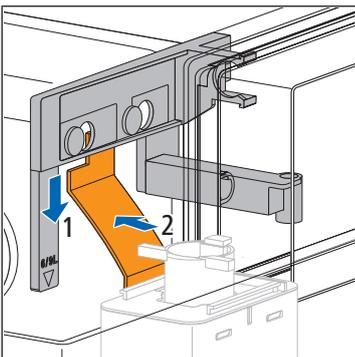
10. Die Sicherung des Füllventilhalters hinter den Füllventilhalter schieben.
