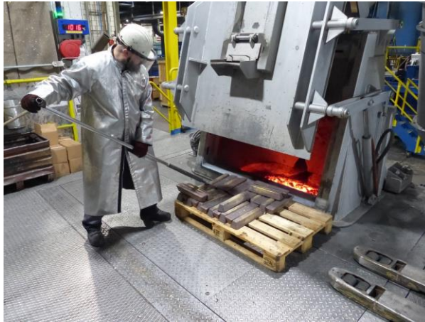
Abbildung 1: Barren aus der neuen Rotguss-Legierung werden in den Schmelzofen eingebracht. Mit der Schmelze kann anschliessend der Vergiessofen nachgefüllt werden.
