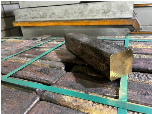
Abbildung 2: Die neue, patentierte Nussbaum Rotguss-Legierung (RgN) ermöglicht das bleifreie Giessen.
