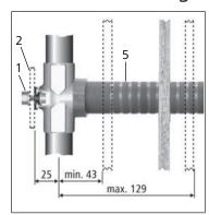
1. Das Unterputz-Ventil mit dem Befestigungs-Set (1) auf die gewünschte Distanz auf die Schiene (2) schrauben.
