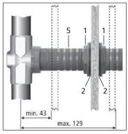
1. Das Unterputz-Ventil mit den Befestigungsmuttern (1) und den Dichtscheiben (2) auf die gewünschte Distanz fixieren.
