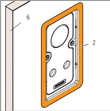
3. Die Fliesen auf das Mass 110.5 x 225 mm zuschneiden und auf die Blende **(1)** aufbringen. Das maximale Aufbaumass **(T)** ist 20 mm.
