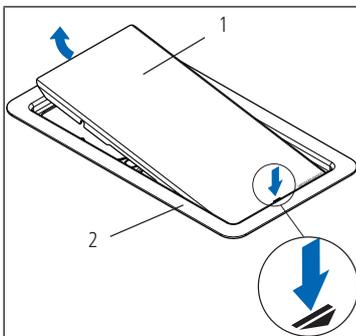
1. Auf die Markierung der Blende **(1)** drücken und die Blende aus dem Grundrahmen **(2)** entfernen.
